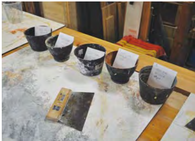
Afb. 33. Preparatie van de verschillende pigmenten voor het maken van scagliola (foto Zoltán Varró)
