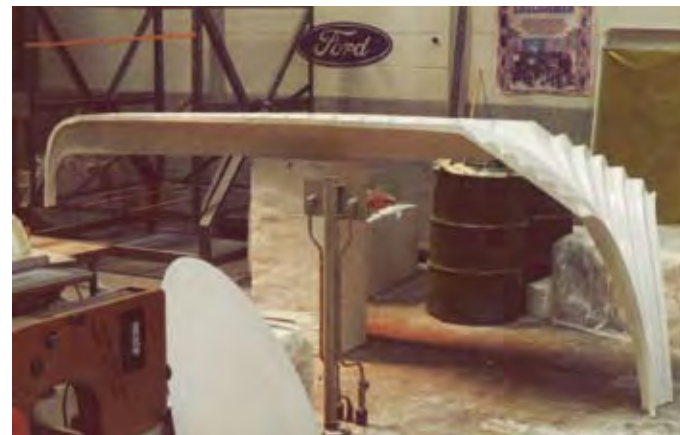
Het eerste model van het bouwelement voor de Shelter in de TNO-werkplaats
