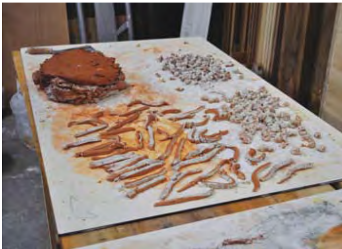
Afb. 34. De pigmenten vermengd met stuc (foto Zoltán Varró)
