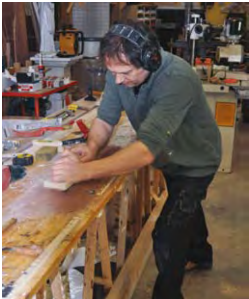
Afb. 35. Het schuren en polijsten van een scagliola plaat (foto Zoltán Varró)
