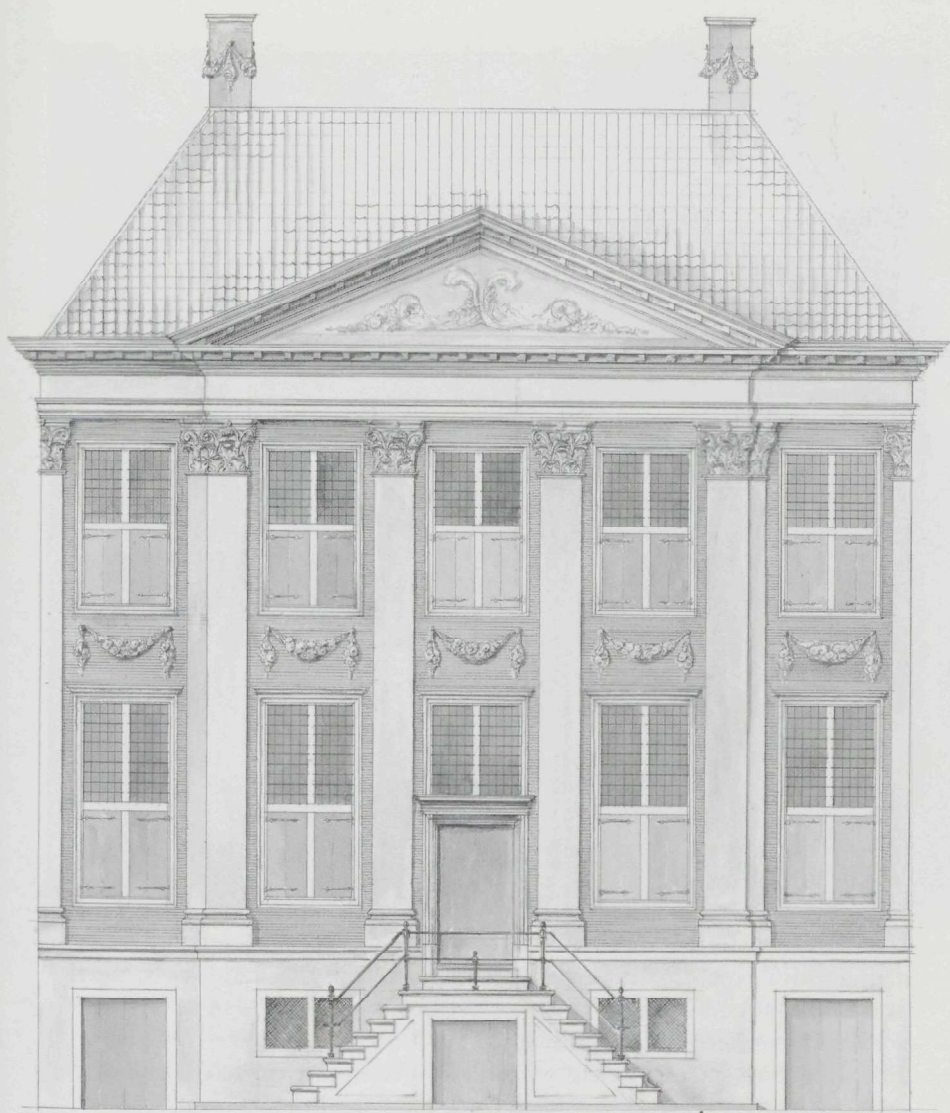
Gevelreconstructies (tekening R. Royaards-ten Holt): toestand na de verbouwing van omstreeks 1800 en oorspronkelijke toestand (1670). De hoogte van het basement werd bij de verbouwing van omstreeks 1800 gewijzigd.
